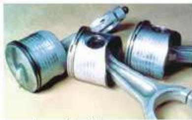
Figure 11a : Worn out pistons.
